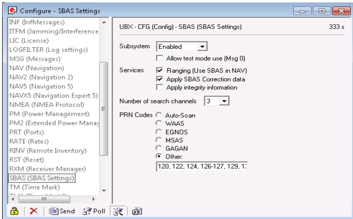
Im NL-6003P ist standardmäßig der Empfang von EGNOS eingeschaltet. Im Konfigurationsmodus können Sie diese Einstellungen kontrollieren. Genauere Infos hierzu entnehmen Sie bitte der aktuellen Dokumentation unter <http://www.u-blox.com>.
